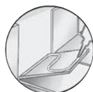
Conexión elástica e impermeabilización
